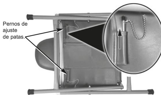
Figura 1 - Localización del perno de ajuste para patas.
